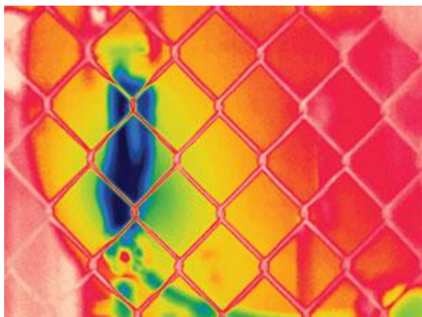
Пассивные системы автоматической фокусировки позволяют снимать только близкие объекты (забор).
