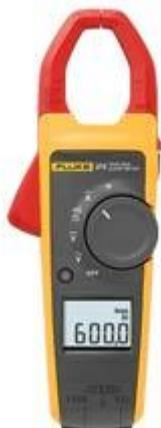
Новые токоизмерительные клещи Fluke 373 обеспечивают повышенную функциональность, что делает их идеальными для любых случаев измерения только переменного тока. Fluke 373 - это все, что вам нужно и даже немного больше. Они позволяют проводить измерение истинного среднеквадратичного значения переменного тока или напряжения, а также измерение сопротивления до 6000 Ом с определением проводимости.
