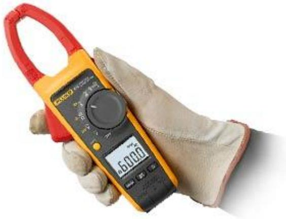
Обладая возможностью измерения истинного среднеквадратичного значения переменного тока и напряжения, прибор Fluke 375 может отображать значения до 600 В и 600 А, как в режиме переменного тока, так и постоянного тока, а также может производить измерение частоты до 500 Гц. Кроме того, модель 375 совместима с новым гибким токоизмерительным датчиком iFlex (продается отдельно), который позволяет увеличить диапазон измерений до 2500 А переменного тока
