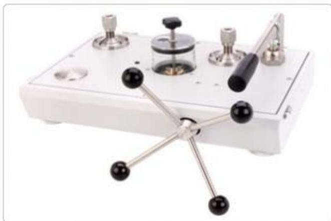
Данные приборы используются для проверки приборов для измерения давления относительно проверочных манометров, индикаторов или датчиков. Такие насосы для гидравлических испытаний обеспечивают быстрое и простое решение для проверки приборов для измерения давления до 140 МПа (1400 бар). Модель 5515, предназначенная для работы с самыми разными жидкостями, обладает рядом свойств нашей популярной линейки грузопоршневых манометров.
