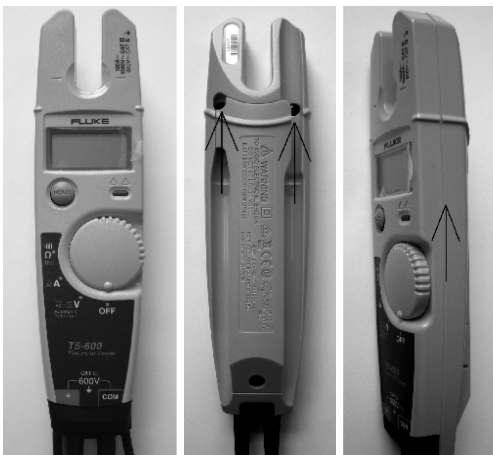
Рисунок 1 - Внешний вид тестеров электрических Fluke T5-600 в разных ракурсах. На нижней поверхности стрелками показаны крепежные винты, которые конструктивно позволяют пользователю при необходимости осуществить пломбирование тестера. На боковой поверхности стрелкой показано место нанесения знака утверждения типа.
