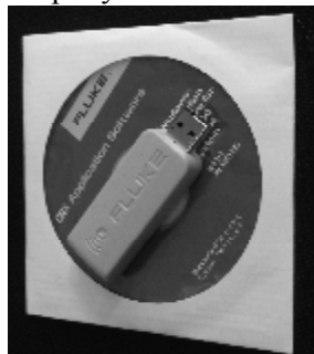
Рисунок 2 – Внешний вид устройства для дистанционного сбора и передачи данных Fluke CNX 3000 PC adapter
