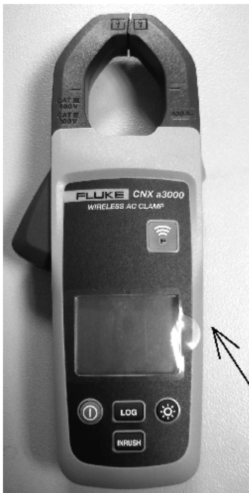
Рисунок 1 - Внешний вид клещей, стрелкой показано место нанесения знака утверждения типа.
