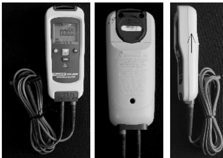
Рисунок 1 - Внешний вид вольтметра переменного тока с функцией дистанционной передачи данных Fluke CNX v3000.
