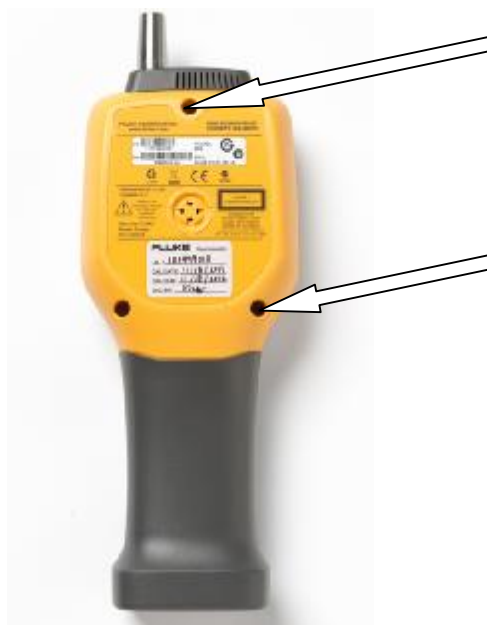
Рисунок 2 – Схема пломбировки счетчика частиц от несанкционированного доступа
