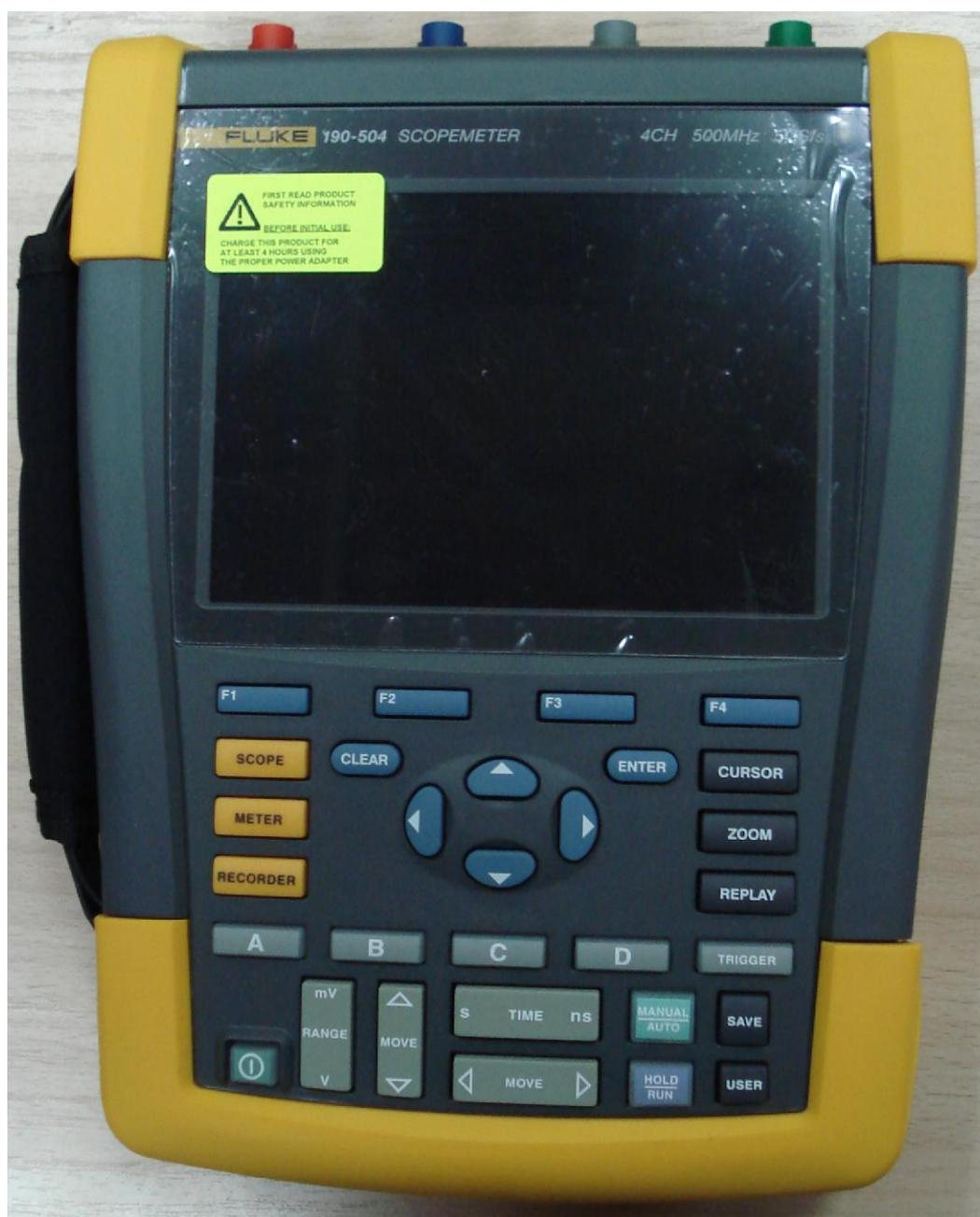
Рисунок 1 – Общий вид осциллографов Fluke 190. Вид спереди
