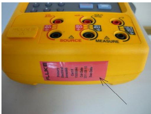
Рисунок 2 - Место пломбирования от несанкционированного доступа
