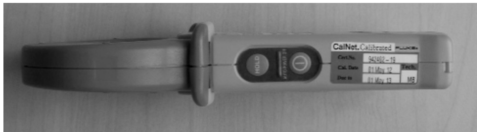
Рисунок 2 - Место пломбирования от несанкционированного доступа
