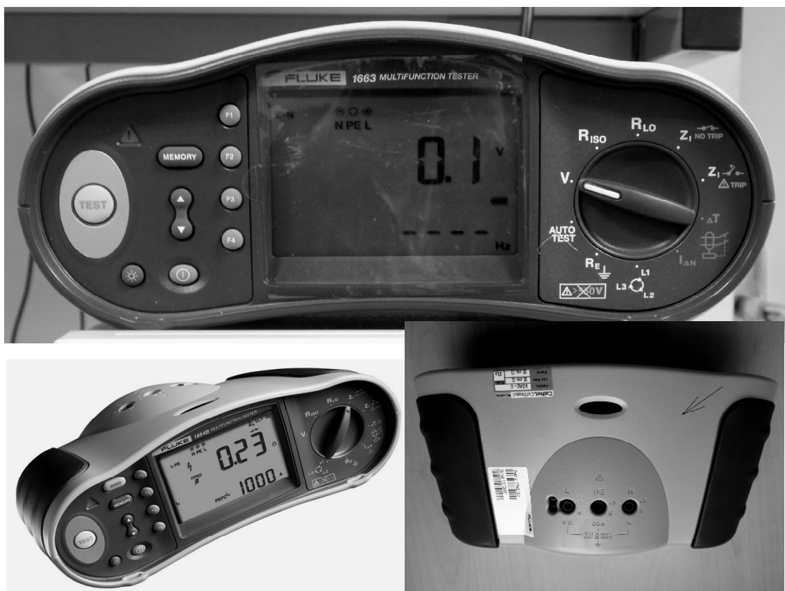
Рисунок 1 - Внешний вид тестеров электрических установок Fluke 1662, Fluke 1663, Fluke 1664 FC в разных ракурсах и при разных масштабах Стрелкой показано место нанесения на верхнюю поверхность корпуса знака утверждения типа и поверочного клейма
