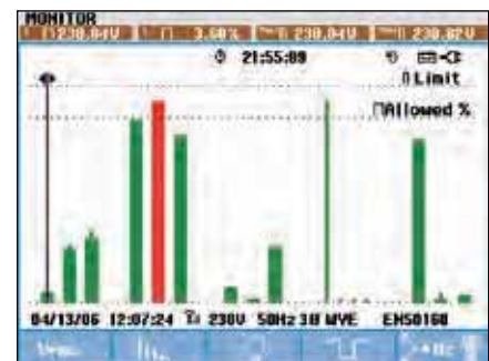
Обзор параметров с помощью Системного монитора дает возможность мгновенно заметить выход за допустимые границы значений напряжения, гармоник, фликера, частоты и количества провалов и выбросов. Предоставляется подробный перечень всех событий выхода параметров за указанные границы.
